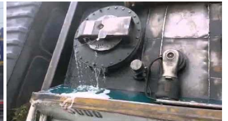
น้ำมันรั่วไหลจากฝาช่องเติมน้ำมัน จ.สมุทรสาคร (กรกฎาคม 2558)
